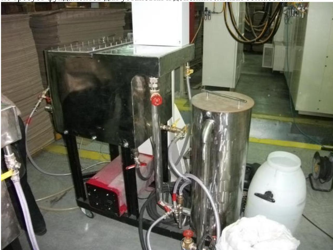
**В состав установки входит:** электрореактор снабженный электродным блоком электродов, миникомпрессор, блок питания, насос для подачи стоков, адсорберы 2 шт, 1 насоса подачи регенерирующего раствора, мешочный фильтр для шлама, модуль утилизации (для возврата цианидов и нейтрализации основной ванны после её загрязнения) 3 шт (по числу ванн улавливания), емкость для регенерирующих растворов (2 шт), приёмная емкость (1 шт).
